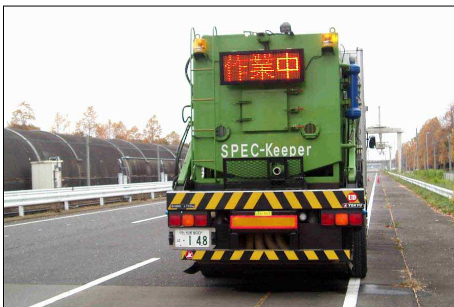
Rys. 46. Samochód do czyszczenia cichych nawierzchni drogowych
