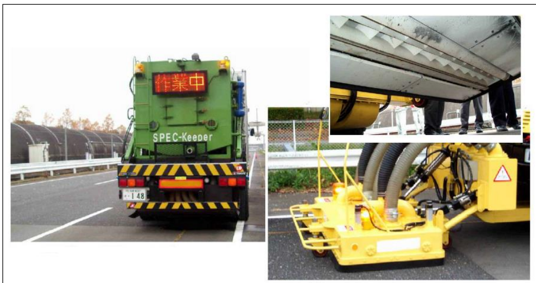
Rys. 5. Sprzęt wykorzystywany przy oczyszczaniu nawierzchni z asfaltu porowatego (Źródło: Zastosowanie nowoczesnych technologii w konstrukcjach drogowych , Zakopane 15-17.09.2010 r.)
