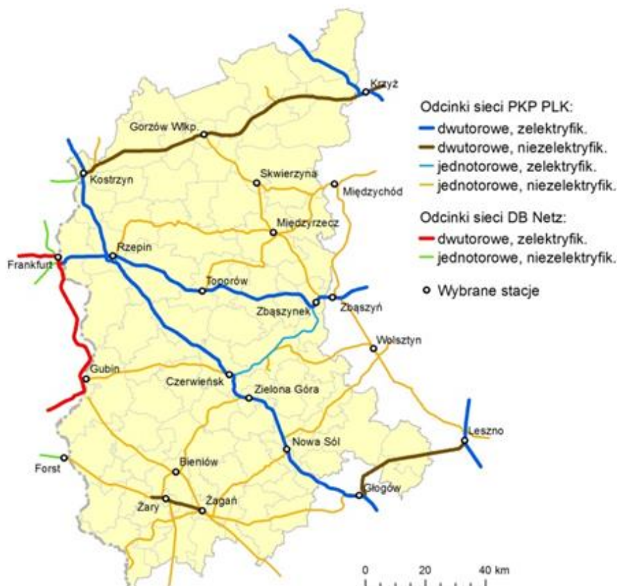
Ryc. 4.8. Schemat sieci kolejowej w województwie i terenach przyległych w 2015 r. – ilość torów i rodzaj trakcji 16
