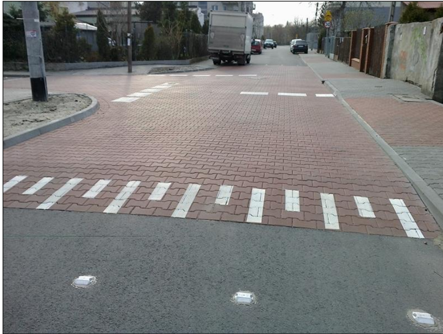
Rys. 4. Przykład wyniesionego skrzyżowania (Źródło: zm.org.pl )
