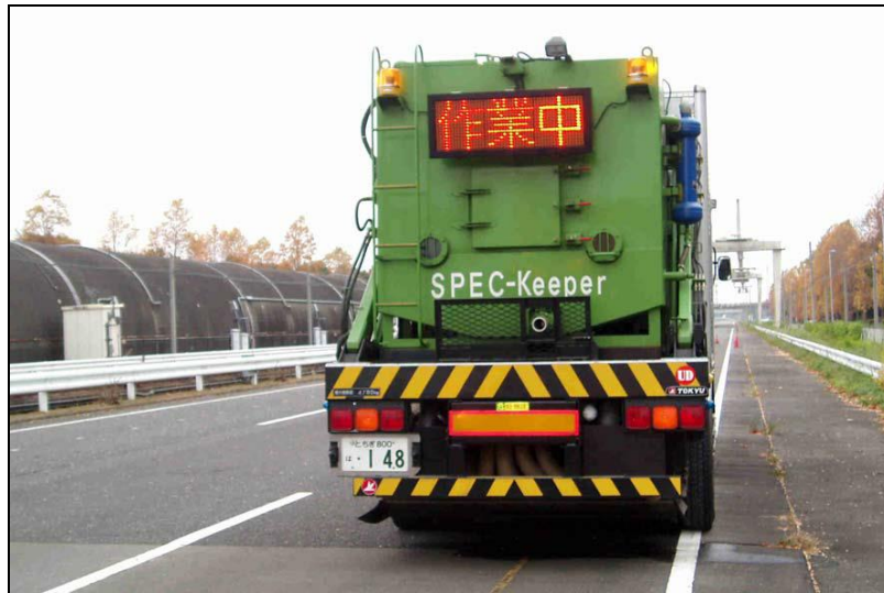
Rys. 20. Samochód do czyszczenia cichych nawierzchni drogowych (źródło: Noise reducing pavements in Japan - study tour report, Danish Road Institute, 2005, DRI-DWW noise abatement program)
