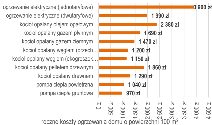
Rysunek 27. Szacunkowe roczne koszty ogrzewania domu jednorodzinnego o powierzchni 100 m 2 i zapotrzebowaniu na ciepło 70 kWh/m 2 /rok
