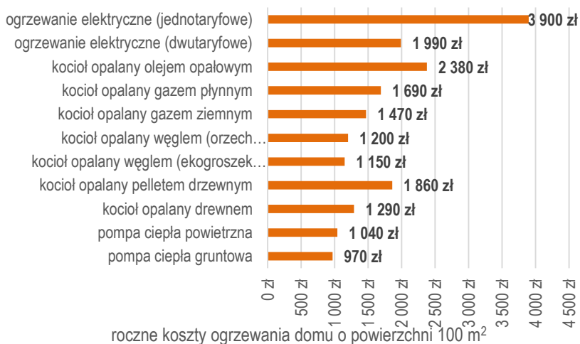
Rysunek 9. Szacunkowe roczne koszty ogrzewania domu jednorodzinnego o powierzchni 100 m 2 i zapotrzebowaniu na ciepło 70 kWh/m 2 /rok
