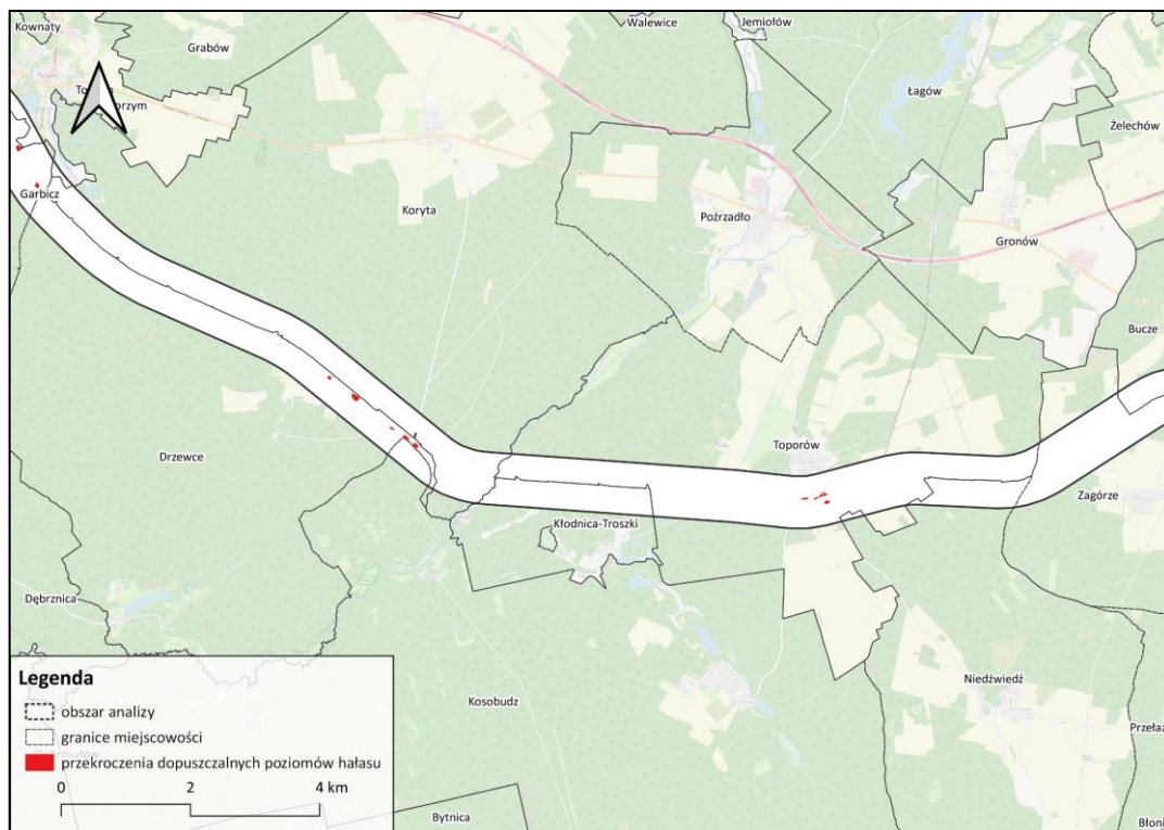
Rysunek 48. Lokalizacja miejsc, w których występują przekroczenia dopuszczalnych poziomów hałasu – arkusz 2 [źródło: Strategiczna mapa hałasu dla odcinków linii kolejowych, po których przejeżdża ponad 30 000 pociągów rocznie. Województwo lubuskie]
