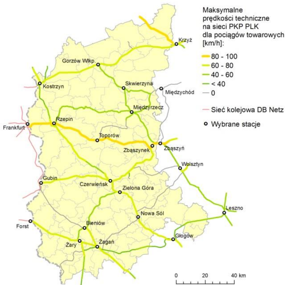
Ryc. 4.11. Maksymalne prędkości techniczne dla pociągów towarowych na sieci zarządzanej przez PKP PLK w 2014 r. 20
