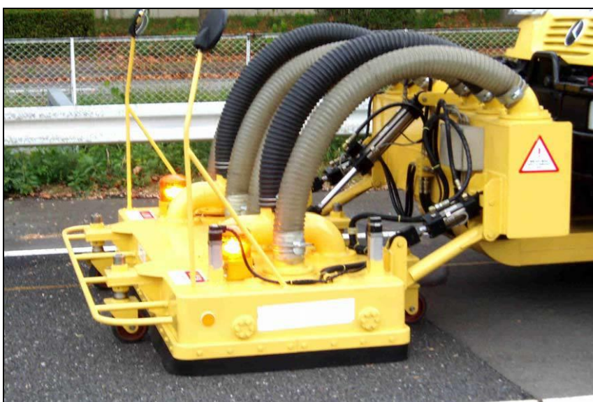
Rys. 21. Czyszczenie cichej nawierzchni drogowej przy wykorzystaniu sprężonego powietrza (źródło: j.w.)
