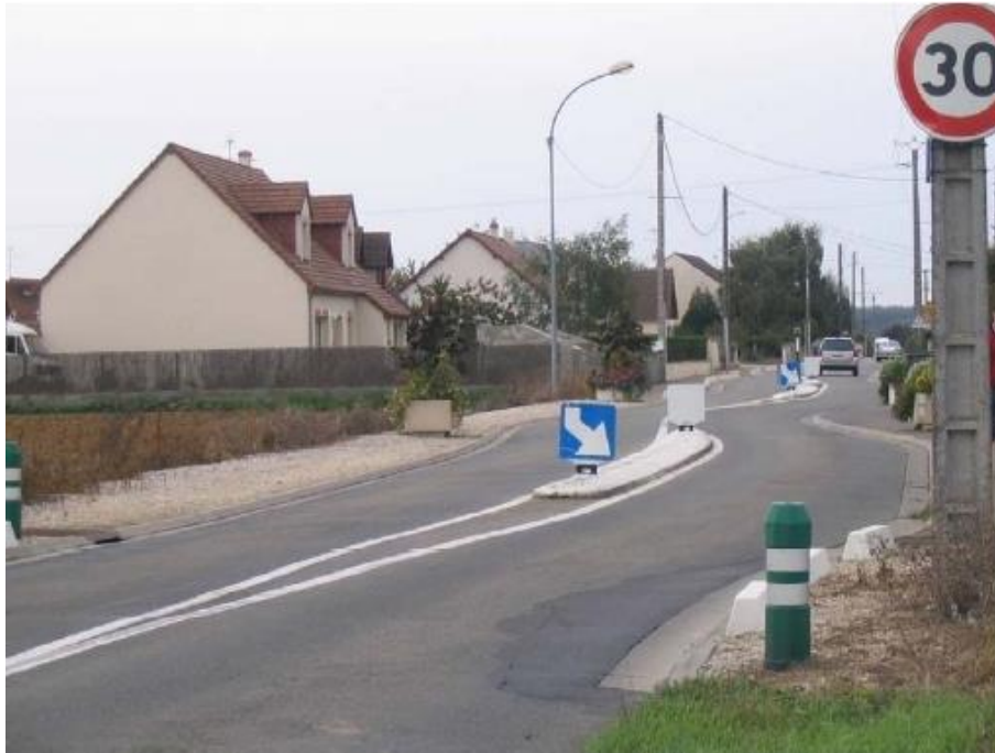
Rys. 7. Przewężenie na drodze – ograniczenie prędkości ruchu
