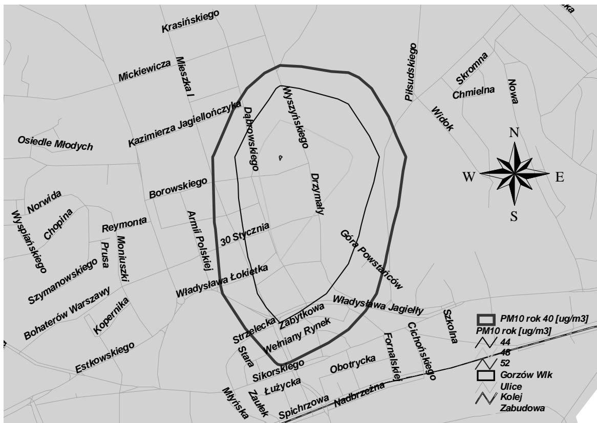
Rysunek 18 Obszar miasta Gorzowa Wielkopolskiego w obrębie izolinii 40 \mu\text{g}/\text{m}^3 , stężenia PM10 rok pochodzące od całości emisji w 2005 r.
