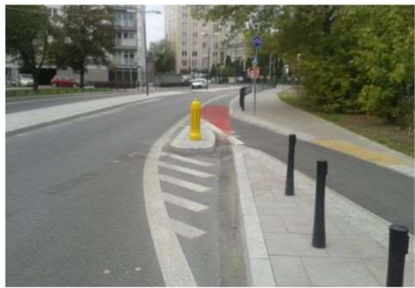
Fotografie 21 Zjazd z jednokierunkowej drogi dla rowerów na pas ruchu dla rowerów z zastosowaniem wyspy ze słupkiem przeszkodowym U-5a.
