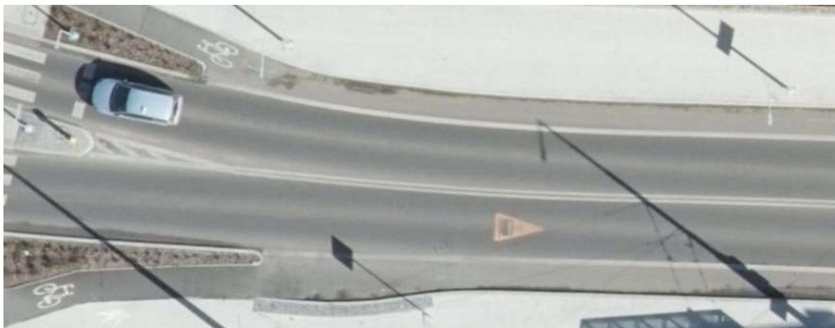
Rycina 20 Obustronne, jednokierunkowe pasy ruchu dla rowerów – ulica dwukierunkowa (Gorzów Wielkopolski, Aleja Konstytucji 3 Maja).
