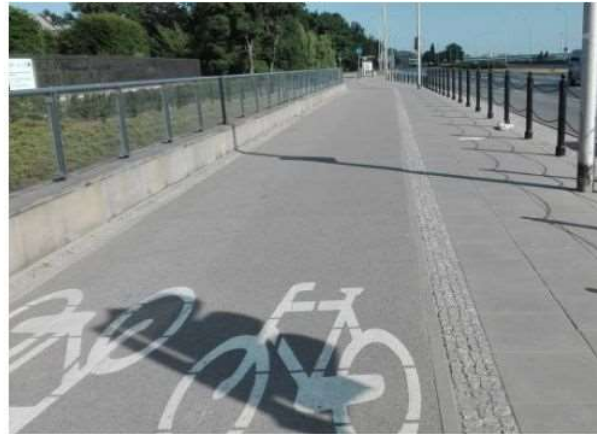
Fotografie 4 Drogi dla rowerów oddzielone od jezdni i chodnika pasami zieleni oraz przebrukowaniem.
