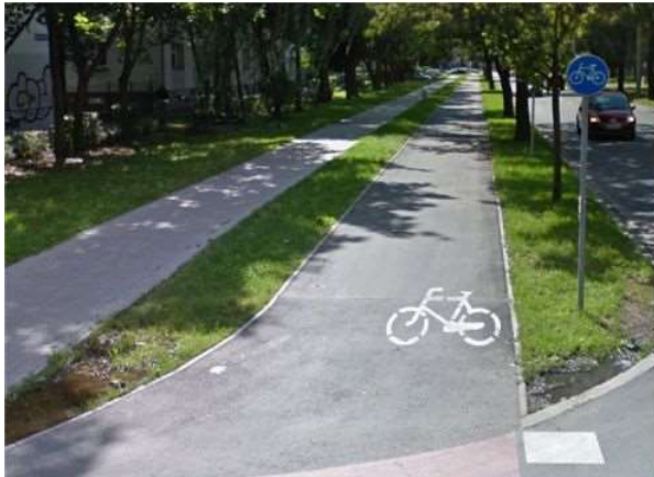
Fotografie 4 Drogi dla rowerów oddzielone od jezdni i chodnika pasami zieleni oraz przebrukowaniem.
