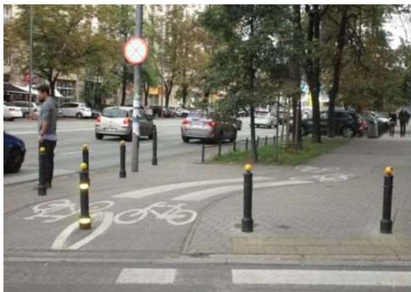
Fotografie 14 Rozwiązania uspokajające ruch rowerowy; od lewej: odgięcie toru ruchu rowerów przed wlotem na skrzyżowanie; zespół progów zwalniających, tzw. fala .
