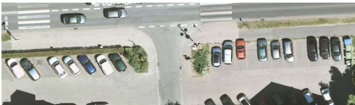
Fotografie 5 Bezpiecznik w postaci zieleni urządzonej (po lewej) oraz brak tego typu bezpiecznika za skrzyżowaniem z drogą podporządkowaną (po prawej) – widoczne zajęcie fragmentów drogi rowerowej przez parkujące samochody.
