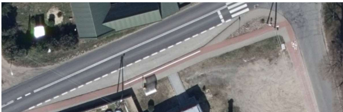
Rycina 18 Droga dla rowerów prowadzona pomiędzy wiatą przystankową a jezdnią w miejscu o niskiej częstotliwości kursowania autobusów (msc. Kolesin).
